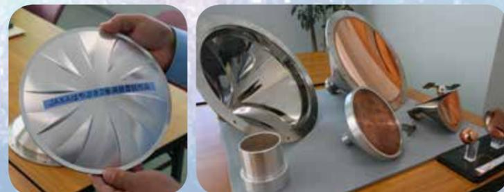
る火薬を含め10kgという制限がありました。火薬は5kg、弾となる銅板は2.5kgとそれぞれ重量が決まっていたため、容器は2.5kgで作らざるを得ませんでした。当初は銅板とアルミ製の容器をネジ留めする手法を採用していましたが、容器の密閉に問題があることが分かり、素材をステンレス製に変更、銅板を溶接する手法へと切り替えました。重量が増えた分、厚さで
