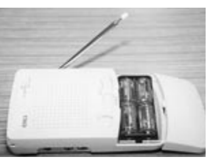
防災無線屋内機
